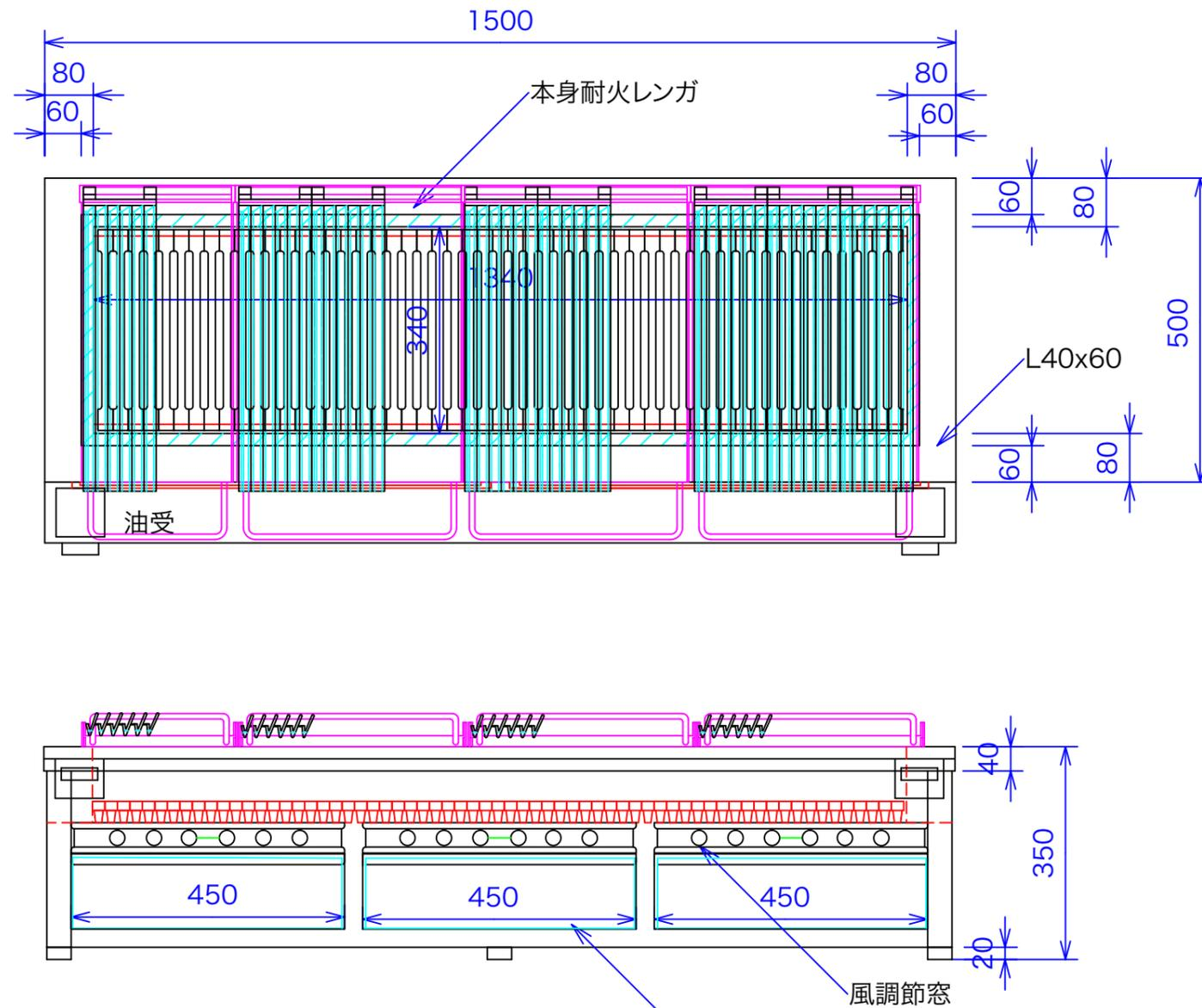
炭の発熱量は1Kgあたり7,000Kcal(8.1Kw)から8,000(9.3Kw)です。炭の種類(普通の木炭、備長炭、高級備長炭等)によって巾があります。記載してある炭参考発熱量はC-600の火床に1Kgの炭を入れるとしてこの機種の火床容量と比例計算したものです。入れる炭の量、炭の起こり加減等で実際の発熱量とは異なります。
